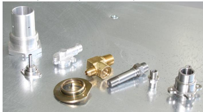
даже зачистка заусенцев. Открылись возможности максимальной концентрации операций для выполнения их на одном оборудовании, что значительно сокращает производственный цикл, а значит и время комплектования всего изделия. Möglichkeit обработки с одного постапнова или только с одной перекладкой обеспечивает
